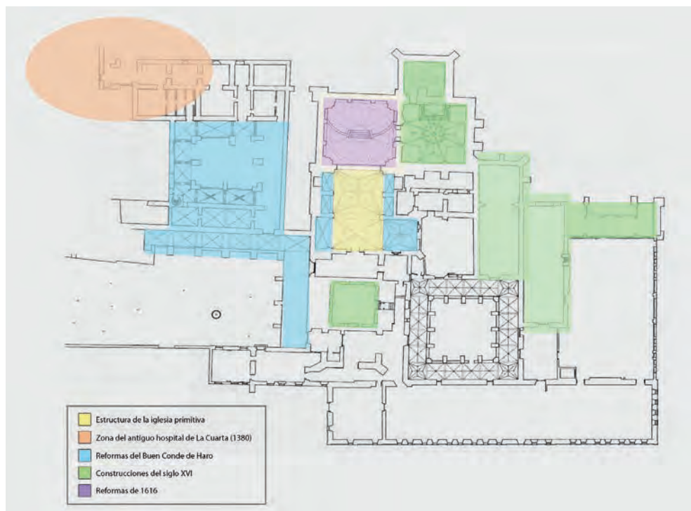
Fig. 2. Plano del monasterio de Medina de Pomar (sobre el plano del Plan Director realizado por José Manuel Álvarez Cuesta) con las diversas fases de construcción
