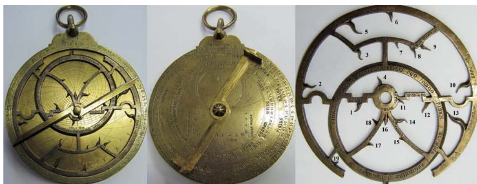
Fig. 6. Frente, dorso y araña con los punteros estelares numerados. Astrolabio atribuido a taller valenciano en ca. 1300. Museo Nacional Marítimo de Greenwich (n o inv. AST 0552). Fotos de la autora con la cortesía del Museo Marítimo de Greenwich
