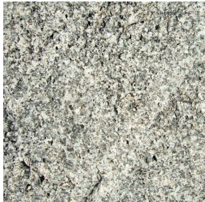
Detalle de un granitoide de tipo granodiorítico biotítico en las canteras del arroyo Ciguñuela en La Lastrilla.
