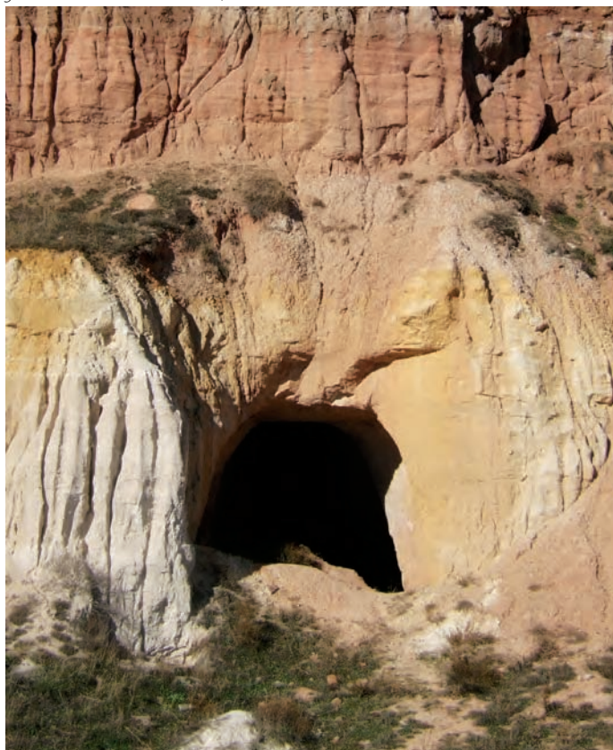
Explotación tradicional de arenas silíceas y arcillas (greda), mediante el sistema de galerías con bóvedas de cañón, en las inmediaciones de Hontoria
