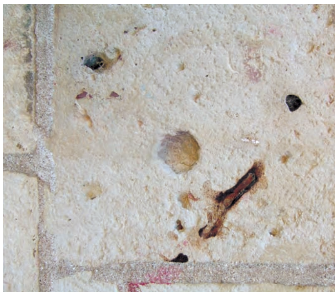
Detalle de un sillar de las calizas y dolomías de San Millán de Segovia, con elementos característicos como las geodas redisueltas y las bioturbaciones con óxidos de hierro
