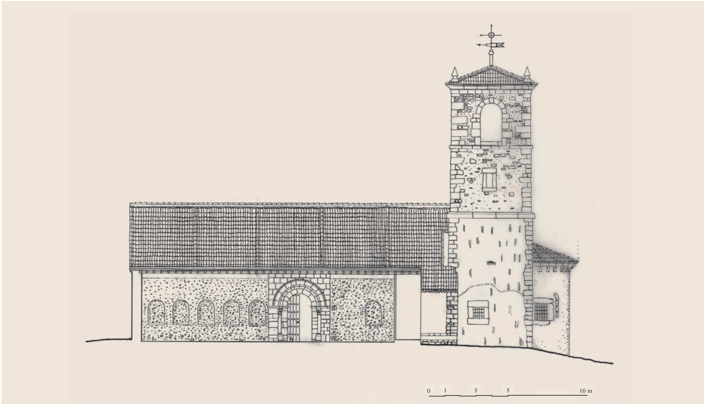
Alzado sur con sección del pórtico
